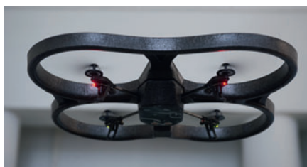
Пенопластовый Parrot AR.Drone 2.0 можно без риска запускать даже в помещении
